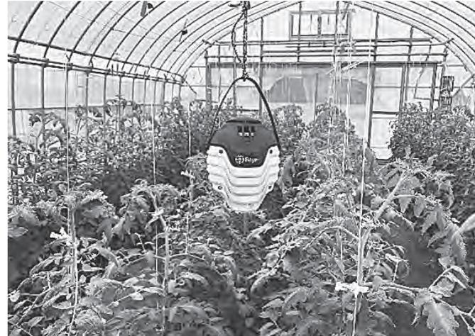
図5 プランテクトの温度・湿度センサー
