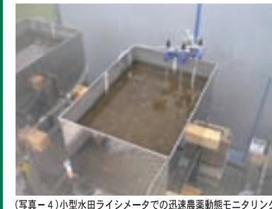
(写真-4) 小型水田ライシメータでの迅速農薬動態モニタリング
