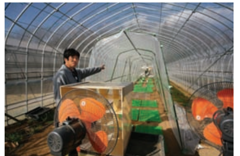
「ドリフトの距離測定試験」のための装置。改良を重ねた最新版が今も活躍中。
